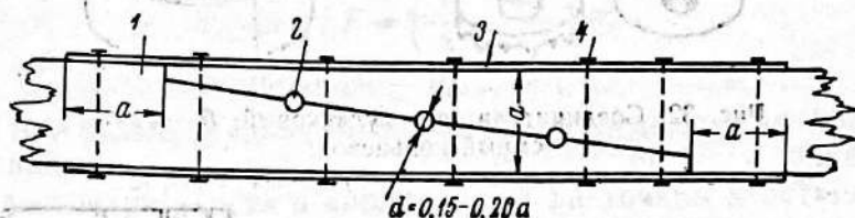
Рис. 31. Косой замок с коксами на двусторонних стальных или фанерных накладках. 1 — соединяемые брусья; 2 — шпонки-кокси; 3 — накладки; 4 — болты.
