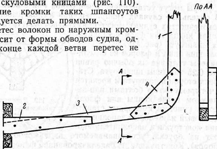
Рис. 110. Натесной однорядный шпангоут из прямослойного леса.
