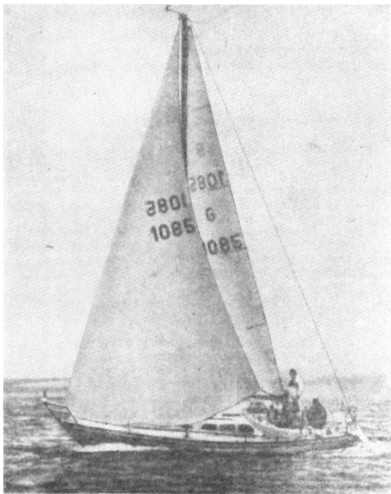
Рис. 174. Нормальный ричер на яхте «Элиза». В отличие от рифтера ставится без штага и имеет больше возможности для настройки благодаря эластичной передней шкаторине.
