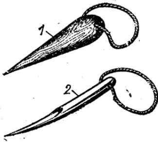
Рис. 208. Свайки — деревянная (1) и металлическая (2).
