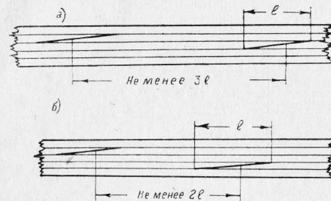
Рис. 45. Расположение усовых соединений в слойчатых деталях.
