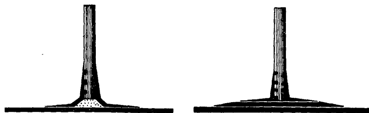
Рис. 136. Виды приформовки внутренних переборок из фанеры.
