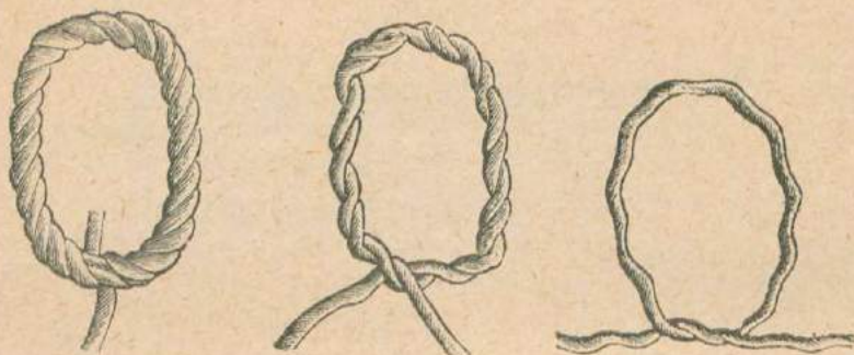
Стропъ для блока безъ сплесня изъ кренгельса.
