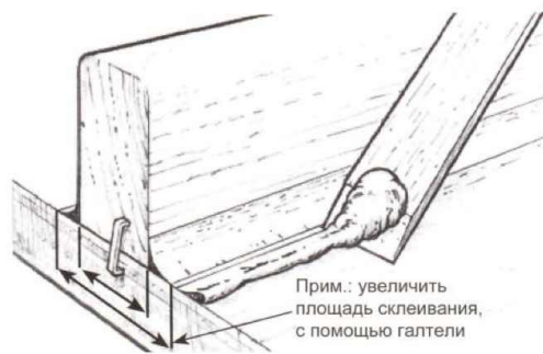
Рисунок 8-13 Удалите остатки смолы до того, как она начнёт застывать.
