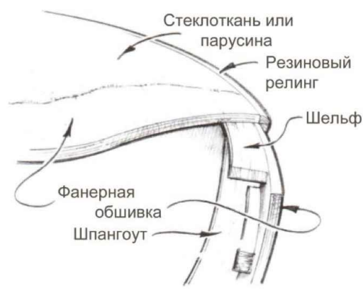
Рисунок 2-3 Типичная фанерная конструкция
