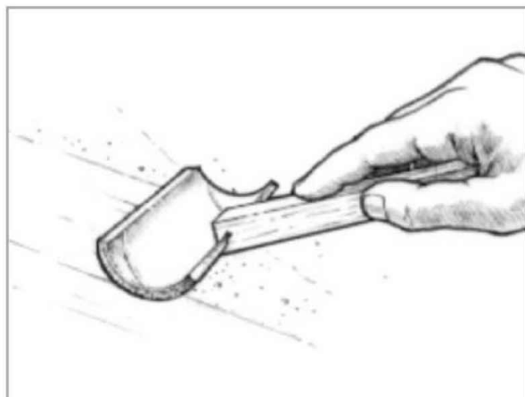
Рисунок 7-4 Разровняйте покрытие с помощью кисти, сделанной из поролонового валика, протягивая её по свеженанесённой смоле
