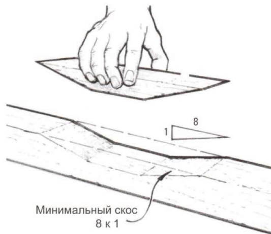
Рисунок 3-3 В большие полости вклеивайте брусок. Сделайте скос кромок полости и бруска.
