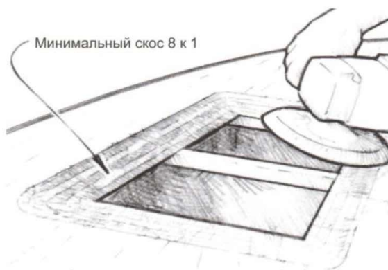
Рисунок 5-12 Вырежьте повреждённый участок и сделайте фаску на всех краях получившегося отверстия с соотношением 8 к 1
