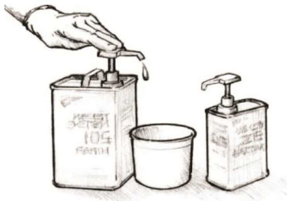
Рисунок 8-4 Налейте смолу и отвердитель в правильных пропорциях
