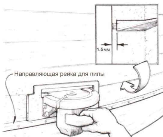
Рисунок 5-1 Используйте дисковую пилу для зачистки пазов обшивки.
