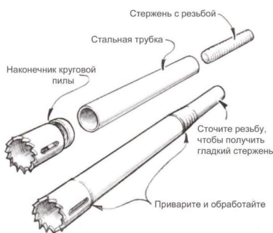
Рисунок 4-13 Круговая пила для килевых болтов, сделанная из трубы, и стандартной круговой пилы.
