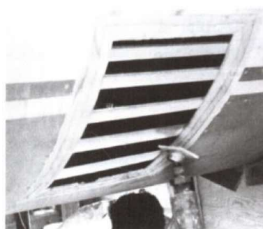
Рисунок 5-16 Скосите кромки отверстия и прикрепите временные стрингеры с обратной стороны.
