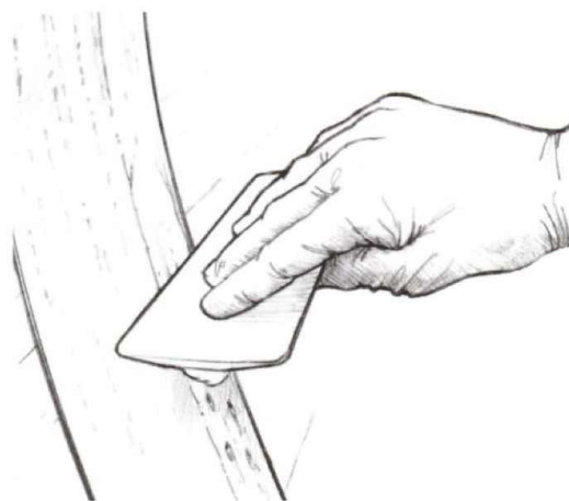
Рисунок 3-5 Заполните оставшиеся неровности эпоксидной смолой с наполнителем низкой плотности.
