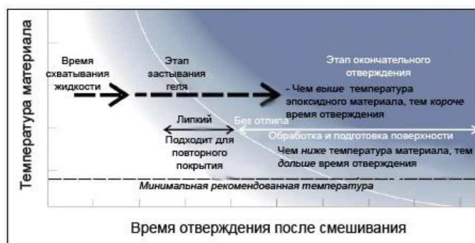
Рисунок 8-3. По мере отверждения, смешанная смола переходит из жидкого состояния, через состояние геля, в твёрдое.
