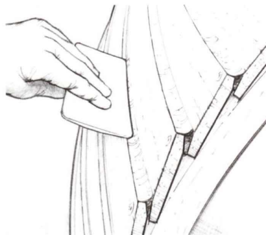
Рисунок 5-9 Заполните пропитанные пазы загущённой эпоксидной смолой.
