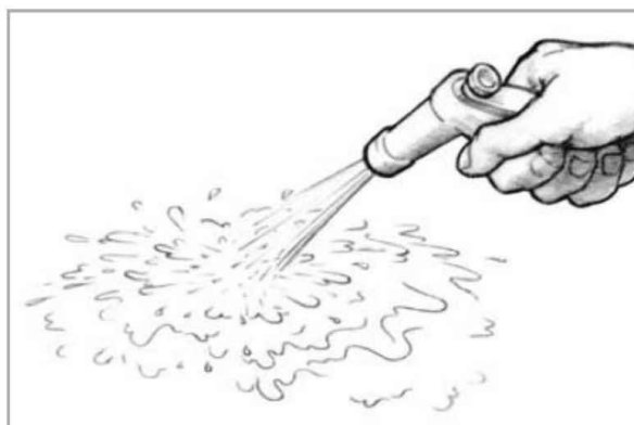
Рисунок 7-6 Сполосните поверхность. Вода должна стекать равномерно, не собираясь в капли, что будет признаком загрязнения поверхности.
